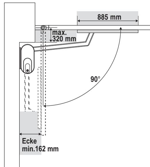
Расположение кронштейна крепления привода:
