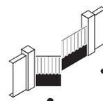
Убедитесь, что в опасных зонах створки ничего не задевают, и не заминают. Обязательно проверьте состояние ворот. Неисправные ворота должны быть отремонтированы и отрегулированы перед установкой приводов. Обязательно проверьте болты и саморезы, входящие в комплект привода Aхovia, чтобы убедиться в безопасности их применения. На время монтажа и настройки приводов обязательно освободите пространство не менее, чем на 500 мм от полностью открытых ворот.
