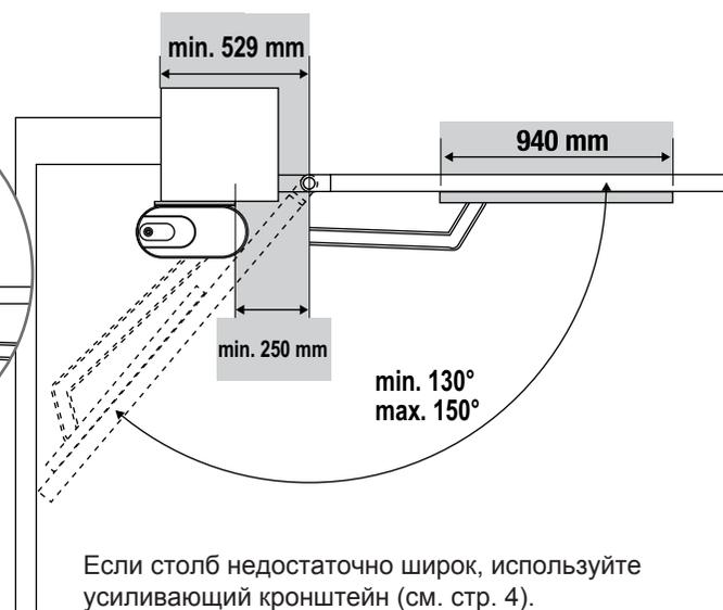
**Расположение кронштейна крепления привода:**
