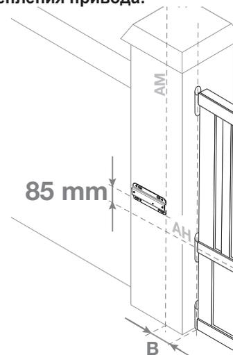
85 мм в случае, если рычаг створки наклонён.
