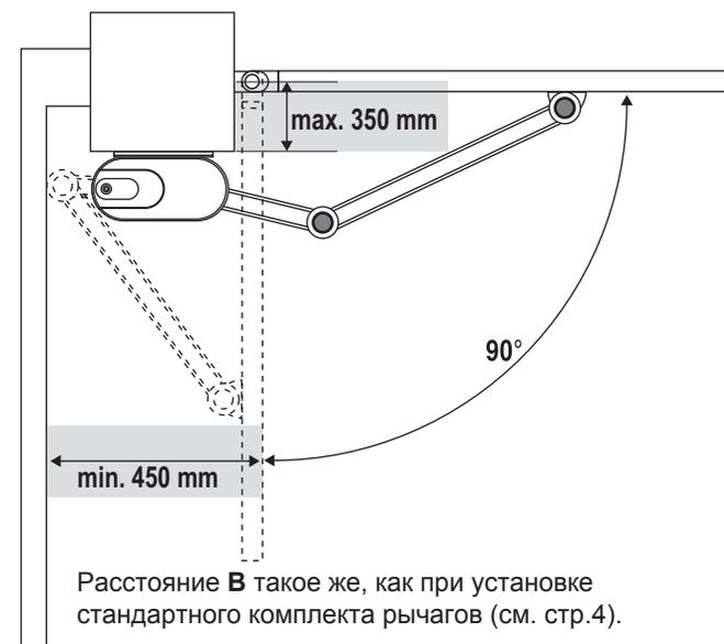
Расположение кронштейна крепления привода:
