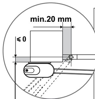
При открывании на угол 150о расстояние В должно быть равно нулю или быть отрицательным.
