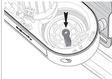
Установите нижний конечный выключатель вплотную к фиксатору (с обратной стороны по отношению к кронштейну крепления привода).
