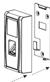
(1) Приложите к стене монтажный шаблон. Просверлите отверстия в соответствии с метками на шаблоне (необходимо просверлить отверстия под винты и кабеля)
