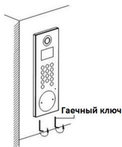
Рисунок 5-5 Затягивание винтов вызывной панели
