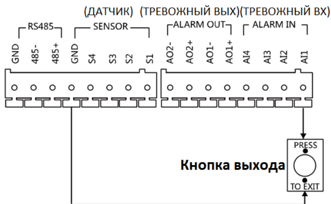
Рисунок 5-20 Подключение кнопки выхода для моделей DS-KD8102-V/DS-KD8002-VM (1)
