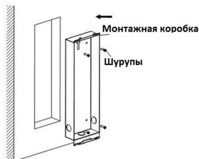
Рисунок 5-3 Установка монтажной коробки в стену
