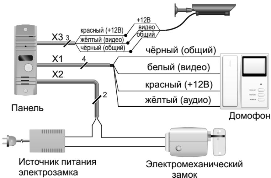
Питание внешней видеокамеры (видеомодуля) +12В осуществляется от домофона. Допускается подключение внешней видеокамеры (видеомодуля) с током потребления до 110 мА. При подключении видеокамеры с большим током потребления и видеокамеры с ИК подсветкой, необходимо использовать отдельный источник питания.
