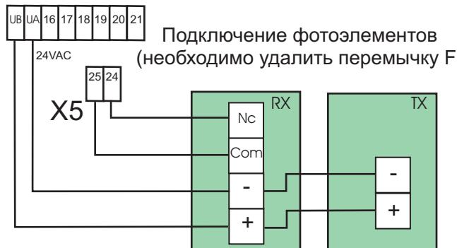
Схема подключения пары фотодатчиков на закрытие
