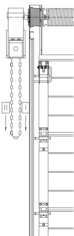
При использовании аварийной ручной цепи от привода отключается электроэнергия.
