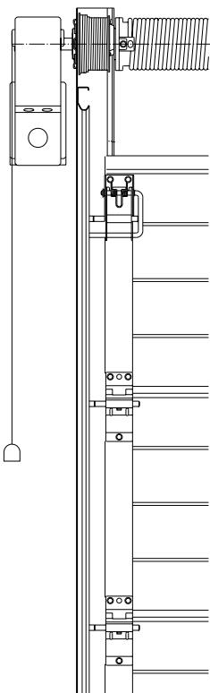
Тянуть тяговый трос с красным колпачком вниэ, натянутый трос согласно маленькоому рис. эавести через крепежный винт и эафиксировать барашковой гайкой. После разъединения быстрой разблокировки, тяговый трос следует обяэательно эафиксировать без натяжения при помоши барашковой гайки, как показано на маленьком рисунке.
