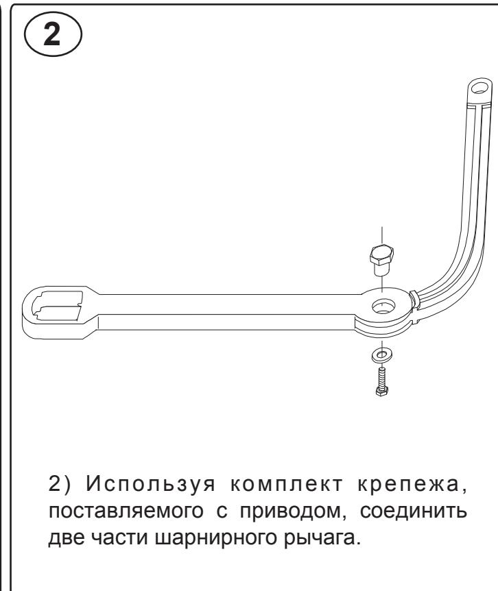
2) Используя комплект крепежа, поставляемого с приводом, соединить две части шарнирного рычага.
