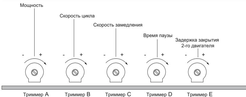
**Триммер А** (мощность): регулирует порог вмешательства электронного ограничителя мощности. Вращение против часовой стрелки увеличивает чувствительность (движение останавливается при более слабом сопротивлении); вращение по часовой стрелке снижает чувствительность и необходимо большее усилие для остановки двигателя; в этом состоянии двигатель может потреблять до 24А (576Вт) при максимальной скорости.
