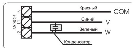
Проверьте, чтобы двигатель был подключен, как показано на рисунке.
