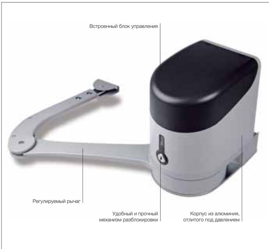
**Для распашных ворот с шириной створки до 3,5 м, в том числе с большими колоннами.** Самоблокирующийся электромеханический привод, 24 В пост. тока, с магнитным энкодером. Рычажного типа. Идеально подходит для интенсивного использования.
