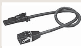
Трехжильный кабель, черный, со штекером для привода и разъёмом Hirschmann для подключения (3 x 0,75 мм²)
