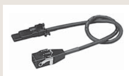
Четырехжильный кабель, черный, со штекером для привода и разъёмом Hirschmann для подключения (4 x 0,75 мм²)
