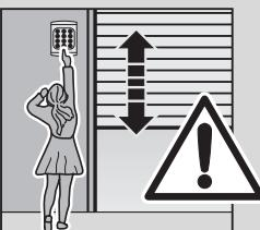
**Aparatele de comandă instalate fix (precum tasterele sau altele asemenea) trebuie montate în aria vizuală a porții, dar la distanță față de elementele mobile. Acestea trebuie fixate neapărat în afara accesului copiilor, la o înălțime de minimum 1,5 metri!**
