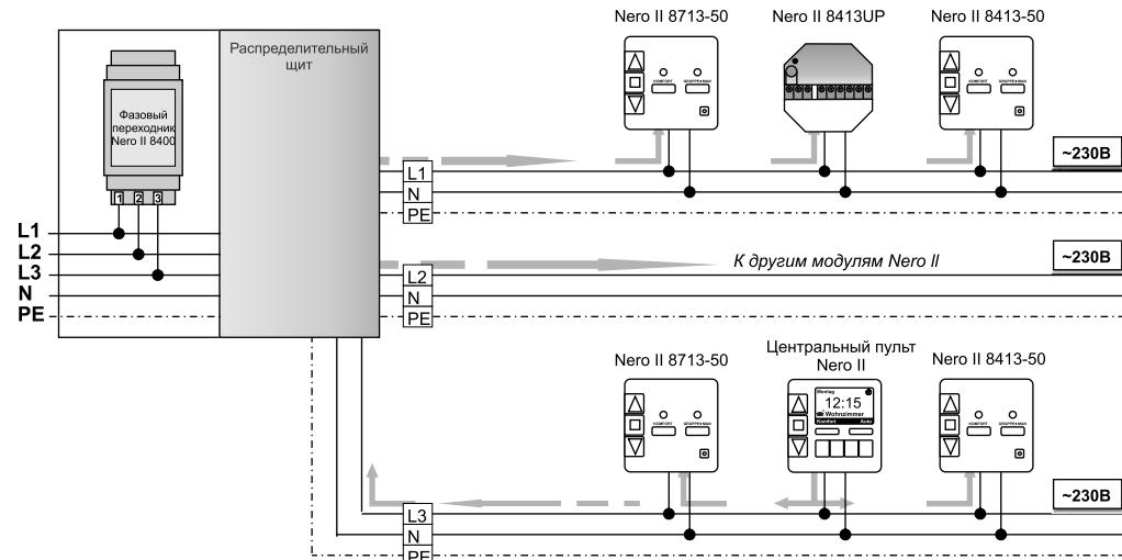
После монтажа фазового переходника в электрораспределительный щит обеспечивается надежная связь между всеми модулями системы, например, между несколькими исполнительными устройствами Nero II, объединенными в одну группу управления, но подключенными к разным «фазам» сети 230В.
