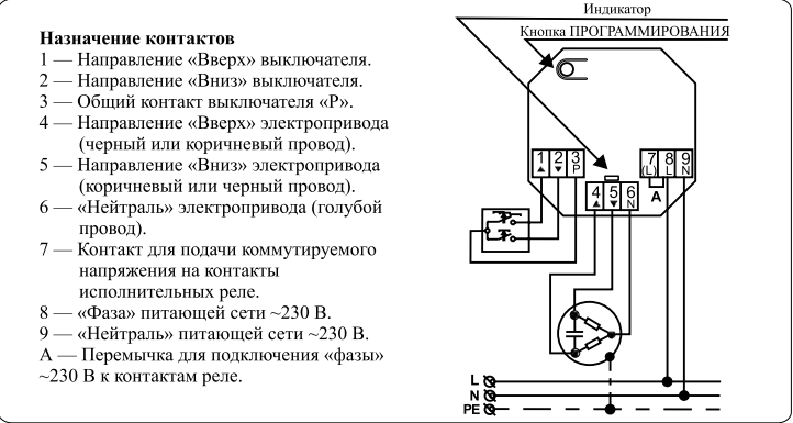
Рисунок 1. Типовая схема подклюния Radio 8113UPM
