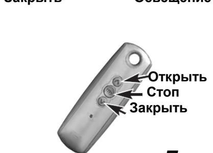
Программирование передатчиков Keytis NS 4 / Telis 1/4 RTS возможно и для стандартного режима с раздельными командами движения:
