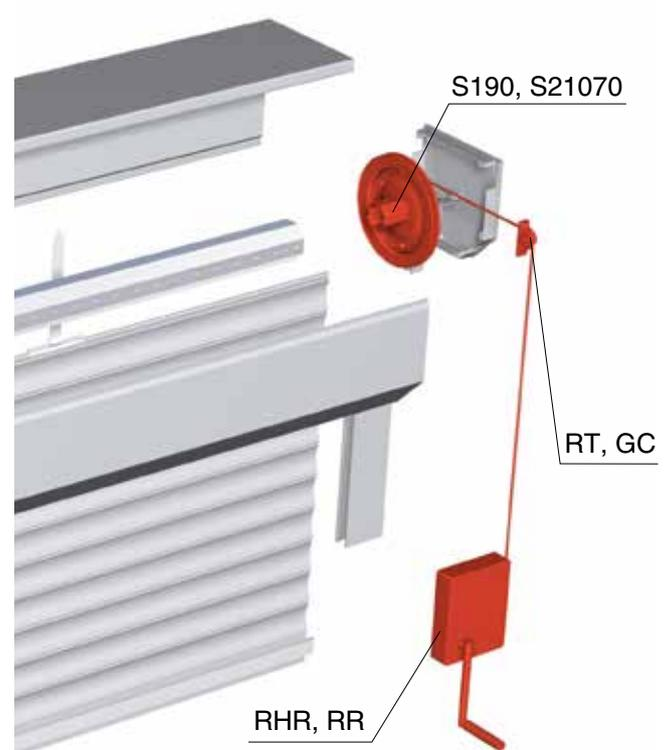
Ручной кордовый привод/Cord crank
