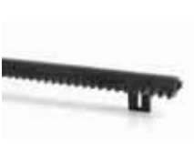
ROA6 Зубчатая рейка M4 25x20x1000мм. Нейлоновая с металлической вставкой. Для ворот весом до 500кг
